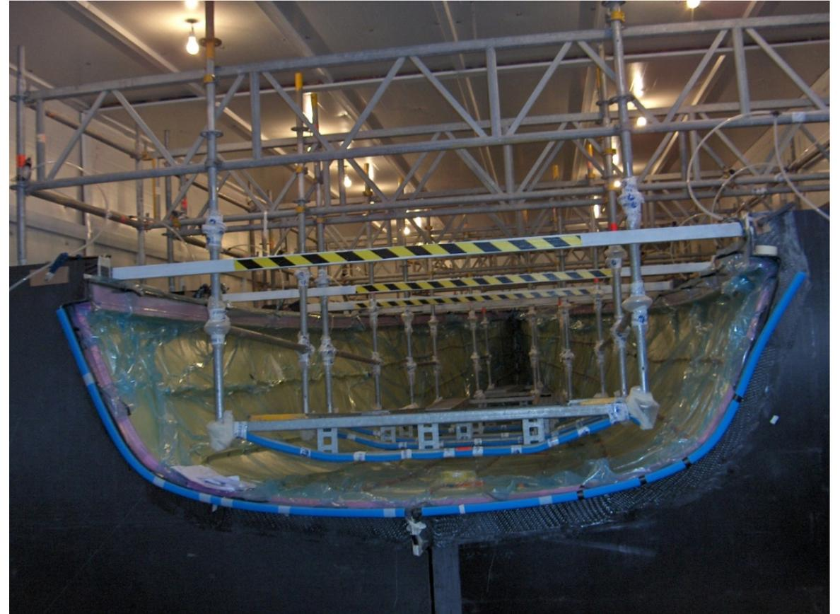
Tras la infusión del casco, es necesaria la fabricación y montaje de la estructura interior del mismo.
