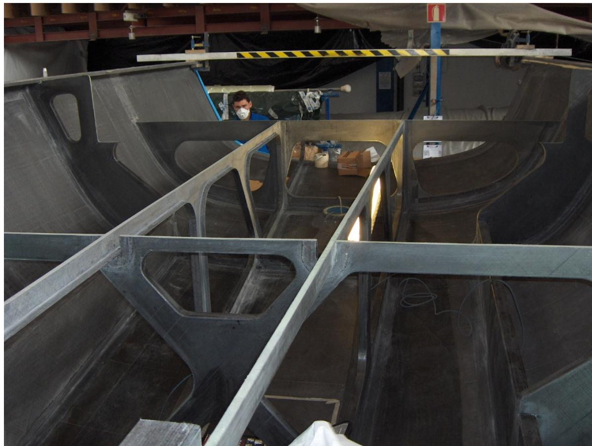
Casco y cubierta se fabricaron por separado para una integración de la estructura completa final por medio de unión adhesivada.
