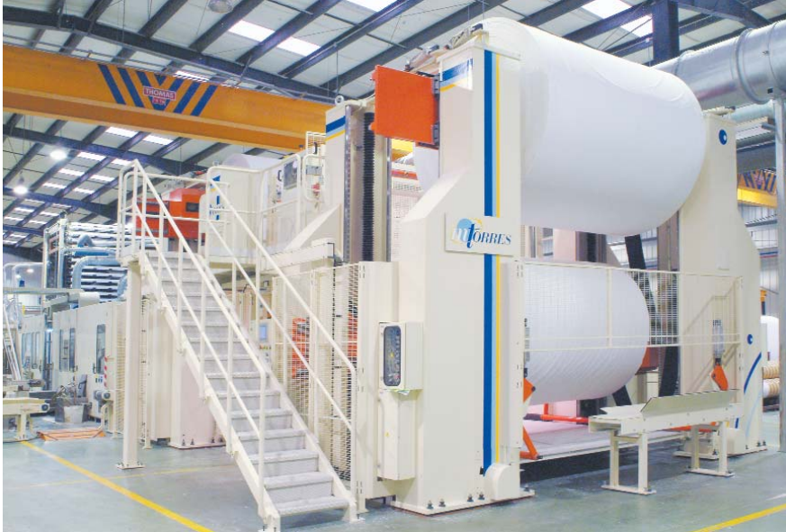
"Empalmadora-desbobinadora" de papel tisú, que sustituye las bobinas de papel manteniendo la velocidad de la línea de producción sin detenerla.
