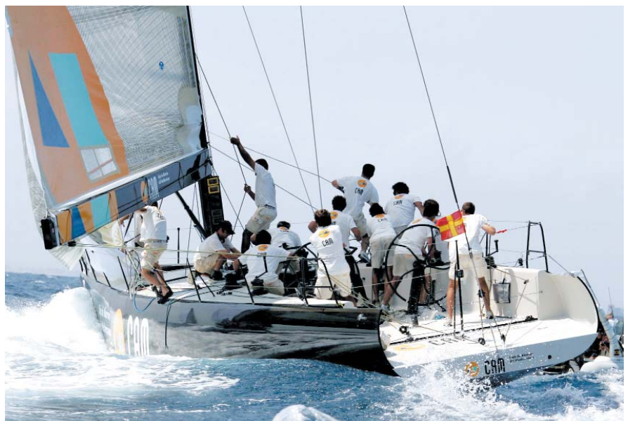
Con los conocimientos adquiridos, MTorres se atrevió a diseñar un barco totalmente distinto a todo lo existente en el sector naval, construido en fibra de carbono y con las formas redondeadas.
