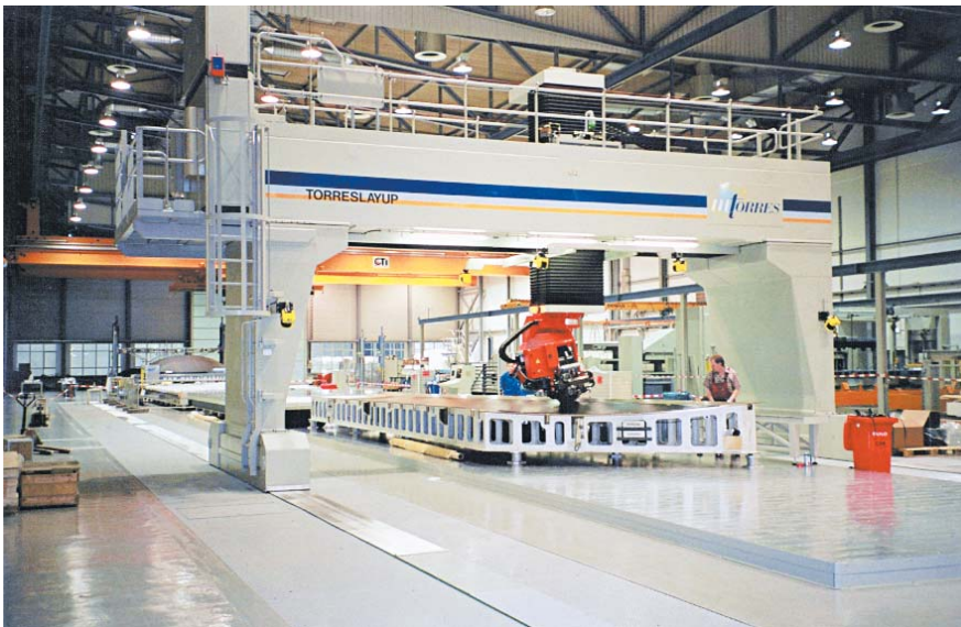
La Torreslavup deposita cinta de fibra de carbono sobre moldes, lo cual poco a poco va generando un aumento de espesor y fabricando la pieza del avión.
