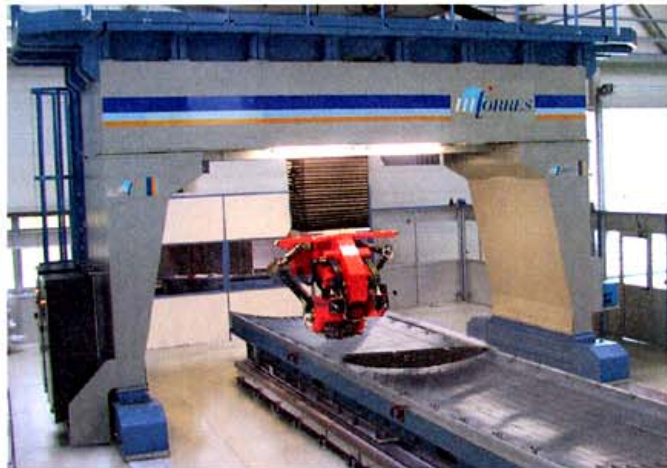
Die Portalanlage ist auf der Oberseite mit zwei diffusionsgekühlten 3,5-kW-CO 2 -Slab-Lasern bestückt.
