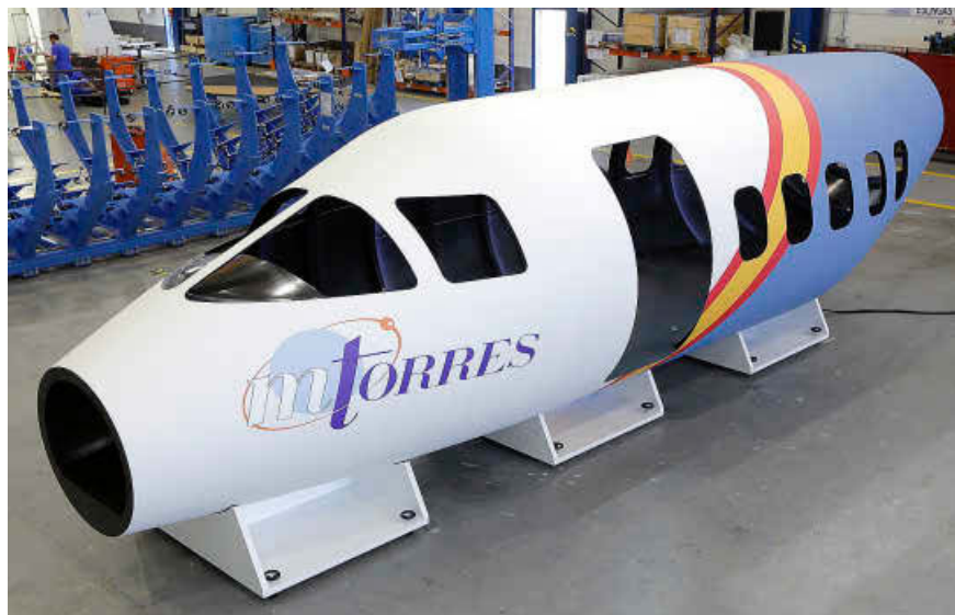
MTorres ha desarrollado un nuevo proceso de fabricación automatizada sin molde para fuselajes monocasco.
